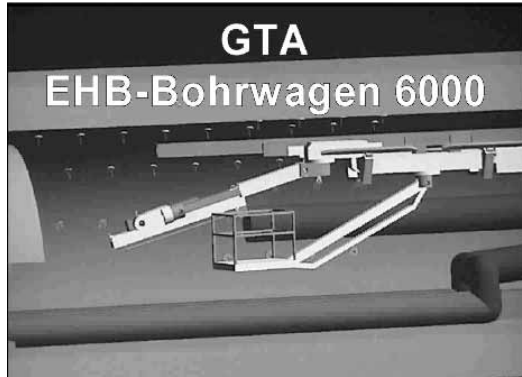
Abbildung 5: Einschienehängebahn für den Streckenausbau in der Simulation
