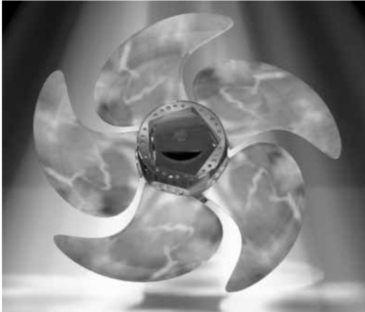
Bild 7: Animation zur Darstellung der Wirkungsweise und der Montierbarkeit eines Verstellpropellers
