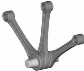
Bild 3: 3D-CAD-Modell der Baugruppe mit Pleuellagerung, 3 Einfachpleueln und Pleuellagerung (Variante 1)
