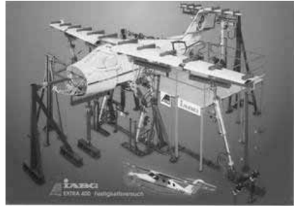
Bild 3 Fatigue Test der Extra 400
