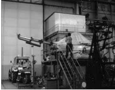
Bild 6 Restfestigkeitsversuch der Flügel
