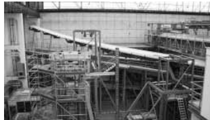
Bild 1 Fatigue Test des A340-600
