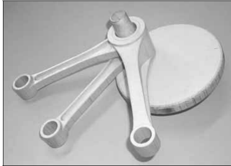
Bild 4: LOM-Prototyp der Baugruppe (Variante 2)
