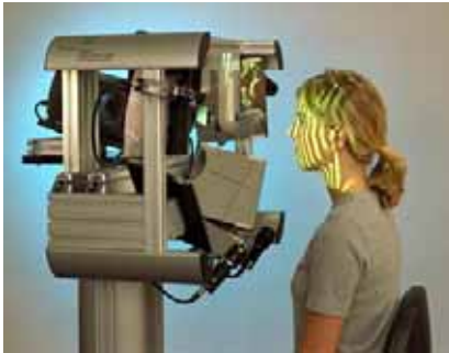
Abbildung 1: Gesichtsscanner arbeitet nach dem Prinzip Streifenprojektion (Quelle: Fraunhofer Institut für Optische Messtechnik)
