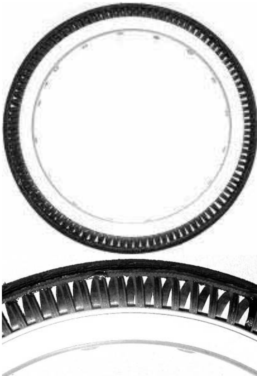
Bild 11: Luftdruckloser Reifen mit FKV-Feder [DE 10123008]
