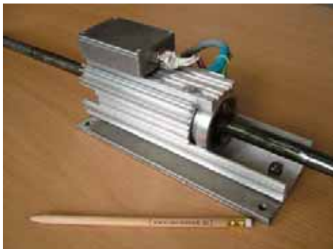
Bild 6: In den experimentellen Untersuchungen eingesetzter Lineargenerator, hier mit einem 950 mm langen Sekundärteil
