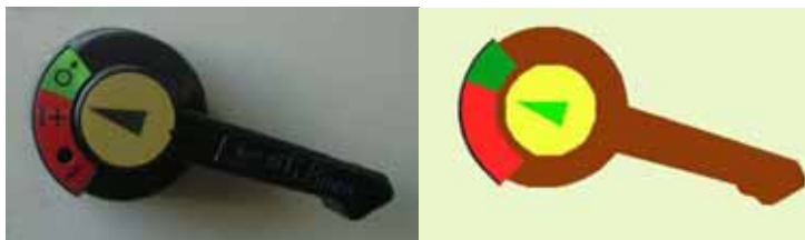
Bild 3: Hauptschalter einer Elektroanlage als reales Objekt und virtuelles Bedienelement
