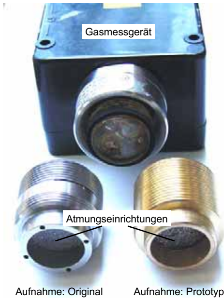
Bild 4: Geteiltes „Ex-d“ Gehäuse mit originaler Aufnahme und einem optimierten Prototyp
