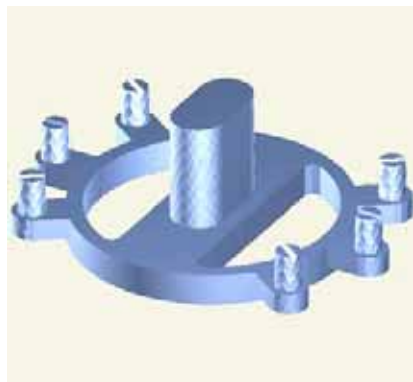
Bild 8: FE-Modell des Versuchsgussstückes mit spannungsoptimiertem Speiser- und Kühlkörpersystem
