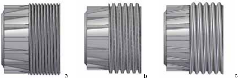
Bild 10: Verschiedene Gewindeformen (a: M36x1,5; b: Tr36x3; c: Rd36x1/8).
